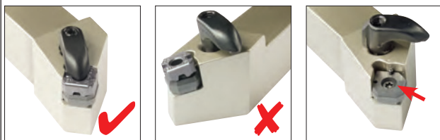
適切なチップ取付 不適切なチップ取付 位置決めピン
