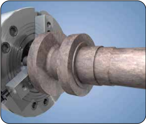
Effettuare smussi e raggi nella fase di preparazione
